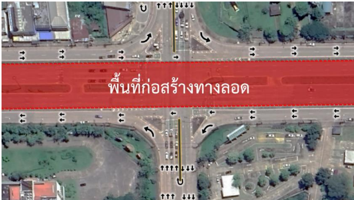
ปิดการจราจรบริเวณทางแยกเพื่อก่อสร้างทางลอดพร้อมจัดให้มีจุดกลับรถบริเวณ หัว - ท้าย ของโครงการ
